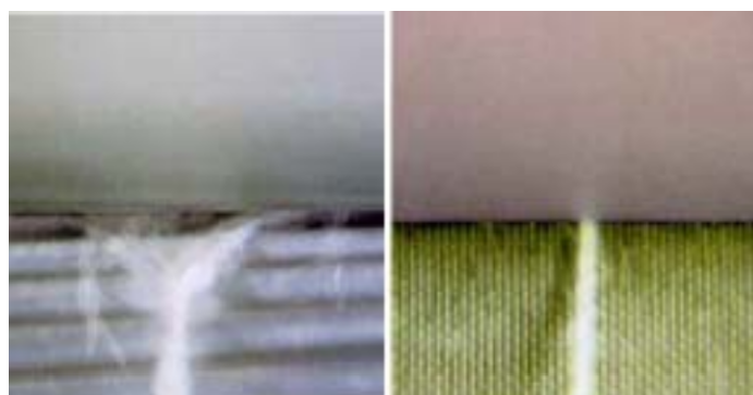
Ilustração 21: Sistema Fiação Anel Convencional e Sistema de Fiação Compacta. Fonte: Suessen EliTe.
