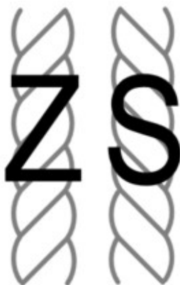
Ilustração 11: Torções Z e S, respectivamente.
