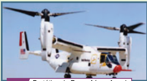
Protótipo da Força Aérea Americana, onde as duas turbinas são basculadas por fusos de esferas.
