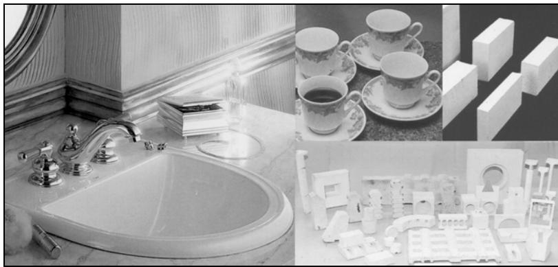
E quais são as matérias-primas que, após o processamento adequado, adquirem essas propriedades? Primeiro, é preciso esclarecer que isso depende do uso que o produto vai ter. Assim, se você quiser fabricar louça doméstica, material sanitário ou material de laboratório para a indústria química, por exemplo, terá que usar argila, caulim, quartzo e feldspato, misturados em diferentes proporções e queimados em temperaturas entre 1.000°C e 1.300°C, de acordo com o produto a ser fabricado.
