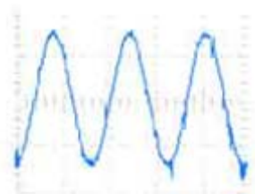
Corrente nos terminais do motor alimentado com tensão PWM
