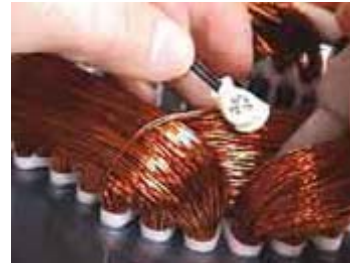
Figura 5.5 - Instalação do termostato na cabeça da bobina
