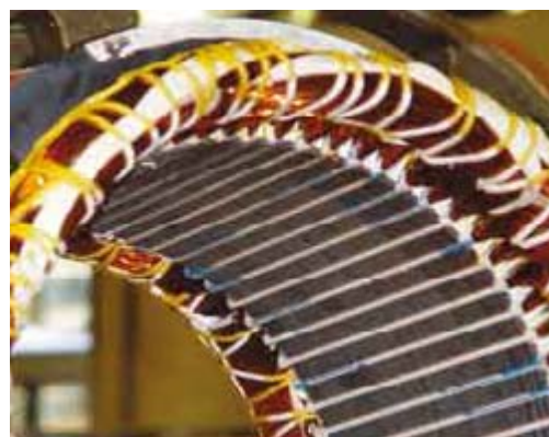
Fig.1.12 – Fios e Filmes aplicados no estator
