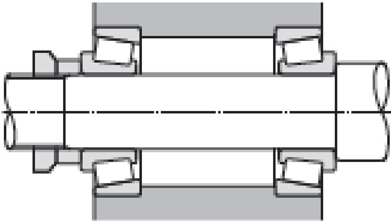
A pré-carga é conseguida ajustando o parafuso.
