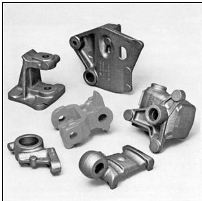
O ferro fundido maleável de núcleo **branco** passa por um tratamento térmico, em atmosfera oxidante, no qual o carbono é removido por descarbonetação, não havendo formação de grafita. Por causa disso, ele adquire características semelhantes às de um aço de baixo carbono e pode ser soldado. É um material indicado para a fabricação de barras de torção, corpos de mancais, flanges para tubos de escapamento.
