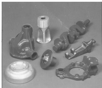
Por causa disso e do menor custo de processamento, está substituindo alguns tipos de aços e os ferros fundidos maleáveis na maioria de suas aplicações. Mancais, virabrequins, cubos de roda, caixas de diferencial, peças de sistema de transmissão de automóveis, caminhões e tratores são produtos fabricados com o ferro fundido nodular. Essas informações estão reunidas no quadro a seguir:
