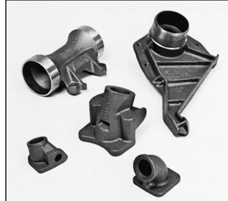
Finalmente, temos o **ferro fundido nodular**, cuja estrutura apresenta partículas arredondadas de grafita. Isso é obtido com a adição de elementos, como o magnésio, na massa metálica ainda líquida. Com o auxílio de tratamentos térmicos adequados, esse material pode apresentar propriedades mecânicas, como a ductilidade, a tenacidade, a usinabilidade e as resistências mecânicas e à corrosão, melhores do que as de alguns aços-carbono.
