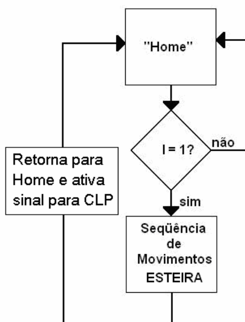
Figura 3.14 - Fluxograma da rotina do robô 1
