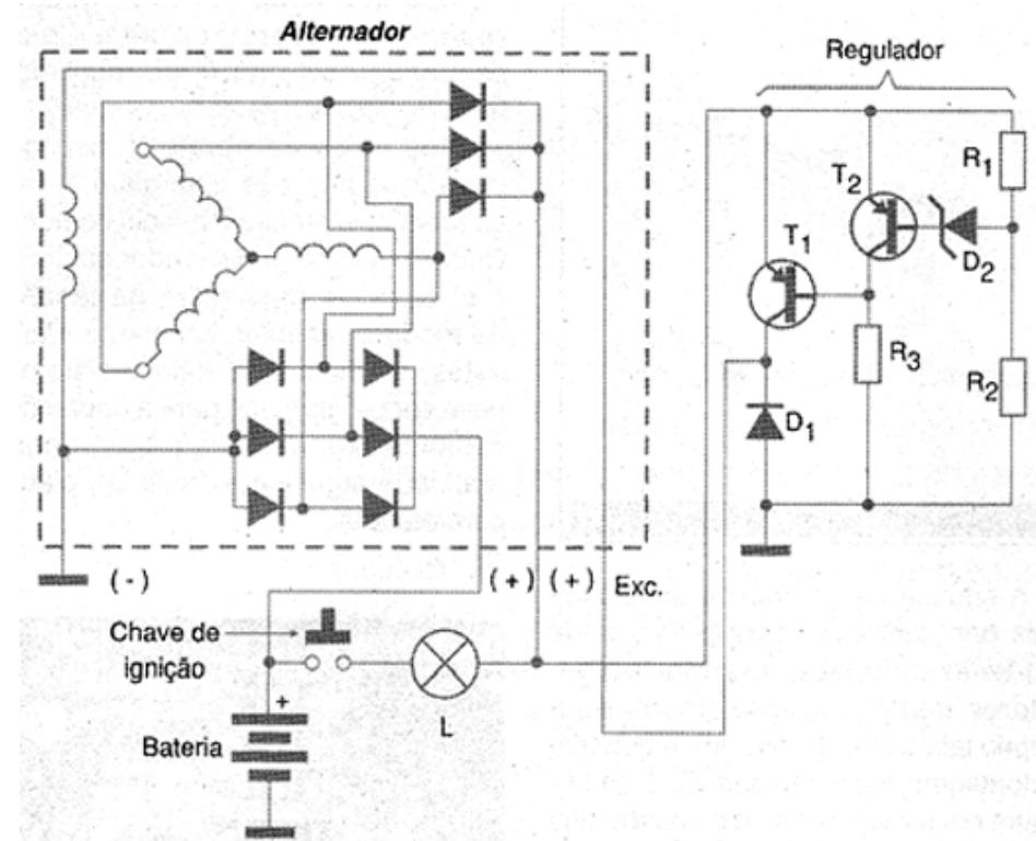
**Alternador com circuito regulador de tensão utilizando transistores de potência.**
