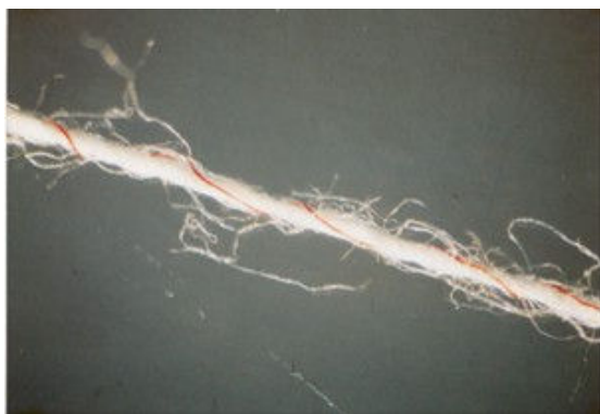
Ilustração 126: Fio sem Goma. Fonte: Guia de Defeitos Industriais Têxteis.
