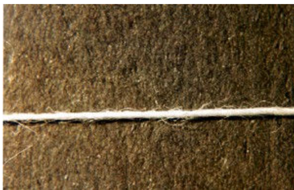
Ilustração 127: Fio Engomado. Fonte: Guia de Defeitos Industriais Têxteis.
