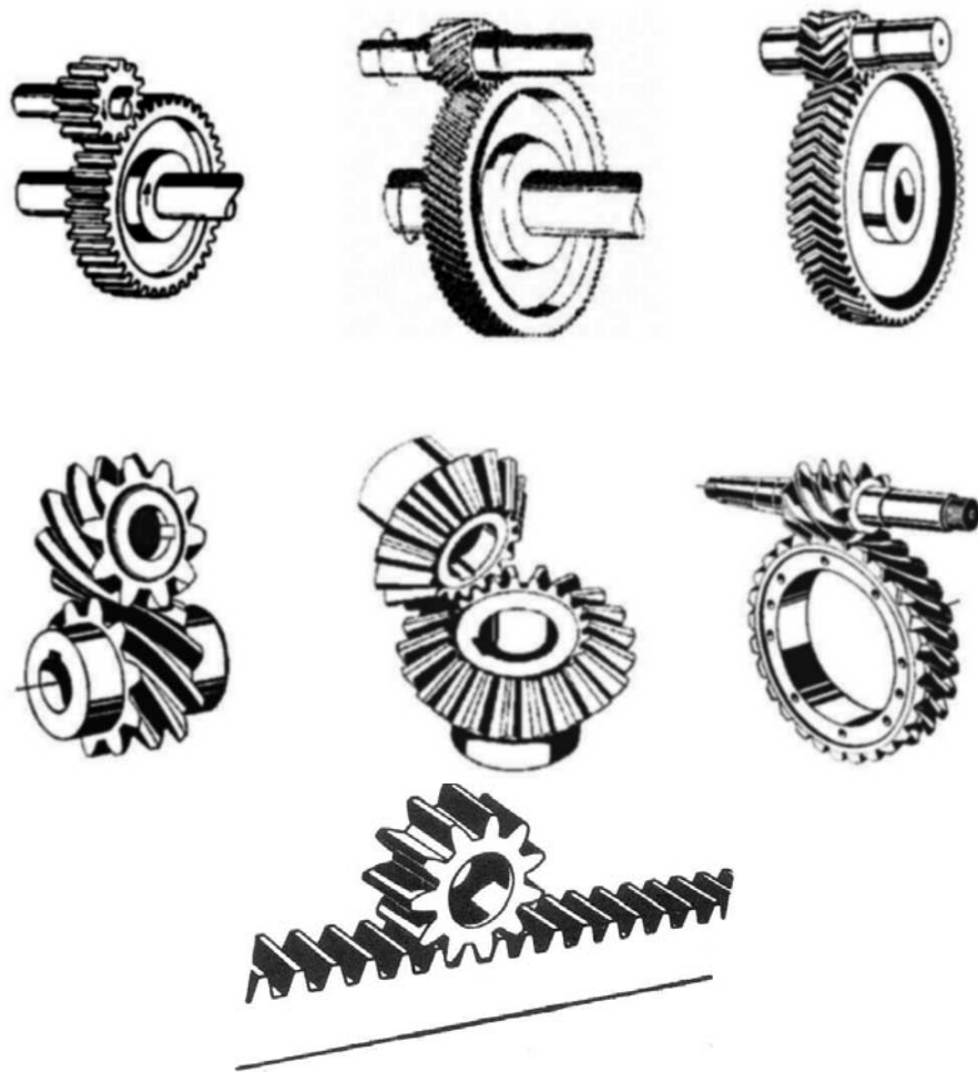
Figura 10.1: Engrenagens cilíndricas de dentes retos, engrenagens cilíndricas de dentes helicoidais, engrenagens espinha de peixe, engrenagens cilíndricas de dentes helicoidais com eixos reversos, engrenagens cônicas, par coroa e sem-fim e engrenagem cilíndrica com cremalheira.
