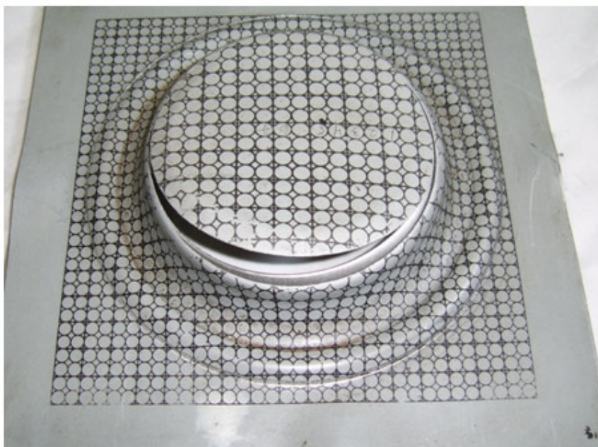
Figura 40 - Corpo de prova 200x200 do ensaio de Marciniak
