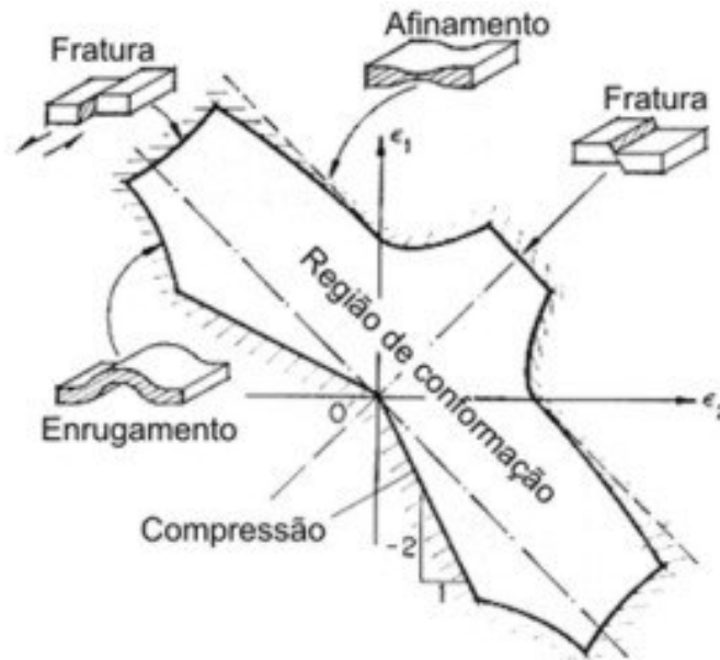
Figura 16 - Representação dos possíveis defeitos na chapa em um diagrama \epsilon_1 \times \epsilon_2 (MARCINIAK E DUNCAN, 1992)
