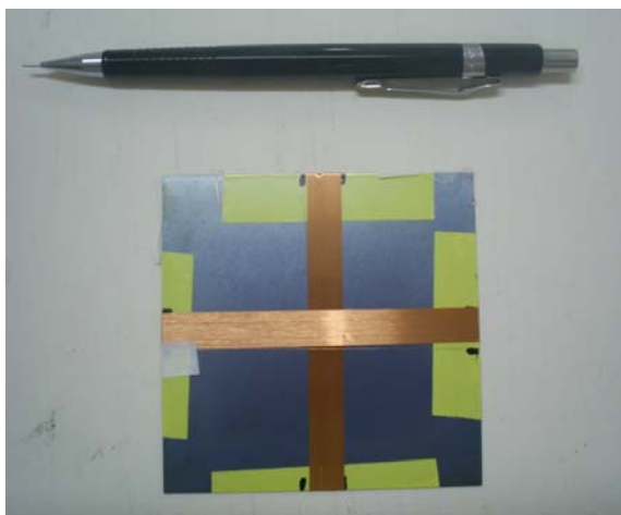
Figura 3.8 – Disposição das bobinas sensoras de indução na amostra.
