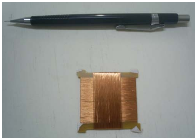
Figura 3.9 – Disposição das bobinas sensoras de campo magnético.
