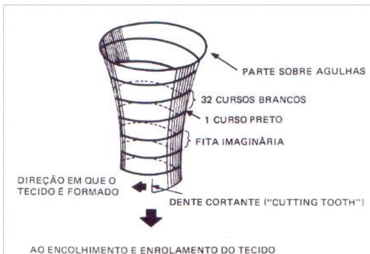
Ilustração 91: Formação Tubular do Tecido de Malha.
