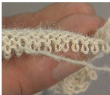
Ilustração 42: Desmalhagem do Tecido de Malha.
