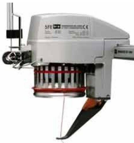
Ilustração 89: Alimentador por Acúmulo (Alimentação Negativa). Fonte: Memminger - IRO.
