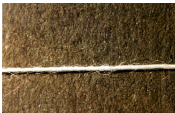
Ilustração 60: Fio Engomado. Fonte: Guia de Defeitos Industriais Têxteis.
