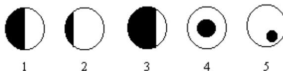
Ilustração 94: Descrição dos Componentes em Fibras Bicomponentes.
