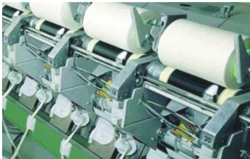
Ilustração 16: Detalhe do mecanismo de fiação Open End (Autocoro Schlafhorst)
