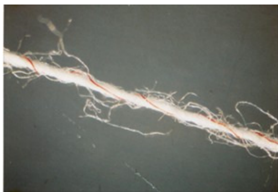
Ilustração 59: Fio sem Goma. Fonte: Guia de Defeitos Industriais Têxteis.
