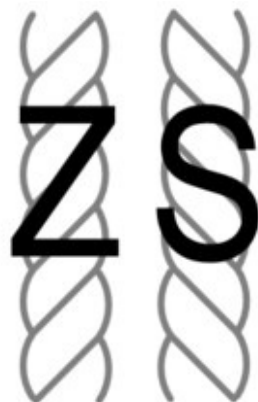
Ilustração 2: Torções Z e S, respectivamente.
