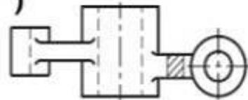
2 - Represente a peça abaixo com vistas auxiliares, à mão livre. Primeiramente, planeje o seu desenho. Tente deixá-lo o mais centralizado possível na folha e com um tamanho proporcional. Pensado o desenho, trace a vista frontal. Depois, use linhas de construção bem fracas para lhe ajudar a traçar as demais vistes (não é preciso a vista lateral).
