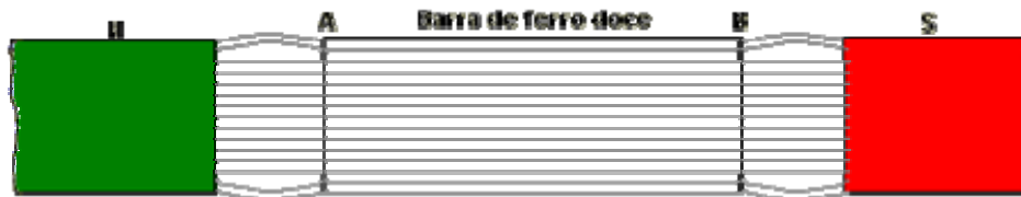
Figura 6.2 - Concentração das linhas de campo devido a um meio de alta permeabilidade.
