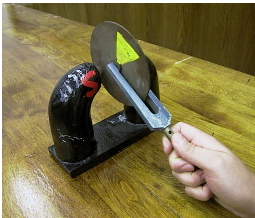
Figura 12.2 - Correntes de Foucault.
