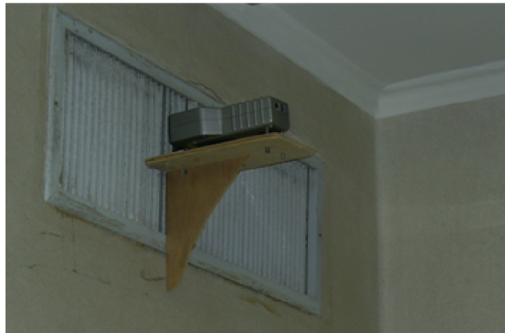
Figura 6.12 – Contador de partículas colocado junto ao insuflamento
