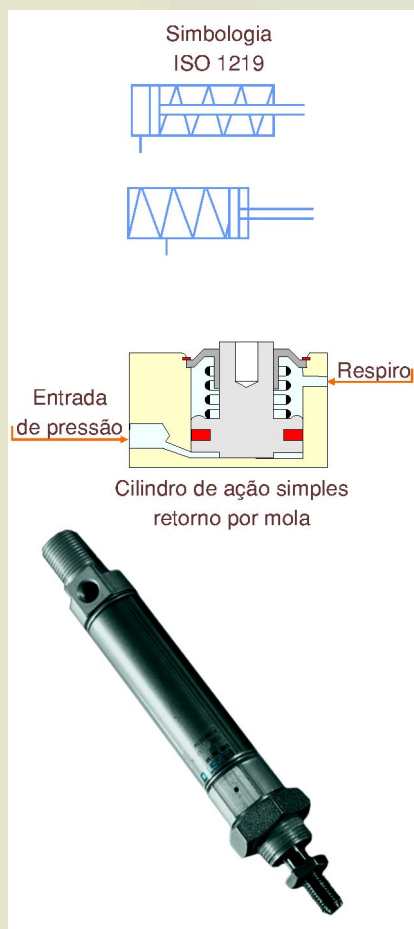
Figura 1 - Atuador pneumático de simples ação (foto, cortesia da FESTO).
