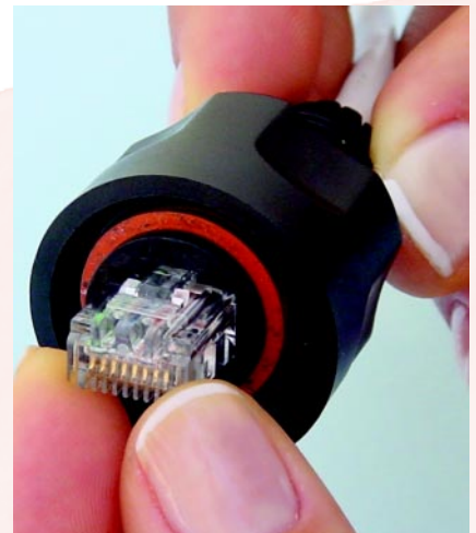
Figura 15 – Colocação do plugue no invólucro.
