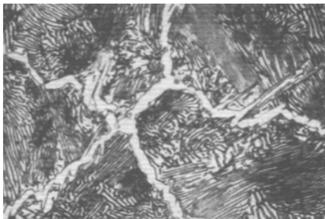
Fig.33 - Microestrutura de um aço hipereutetóide com 1,2%C, resfriado lentamente desde a região austenítica. A cementita é o constituinte branco no contorno de grão da perlita lamelar.
