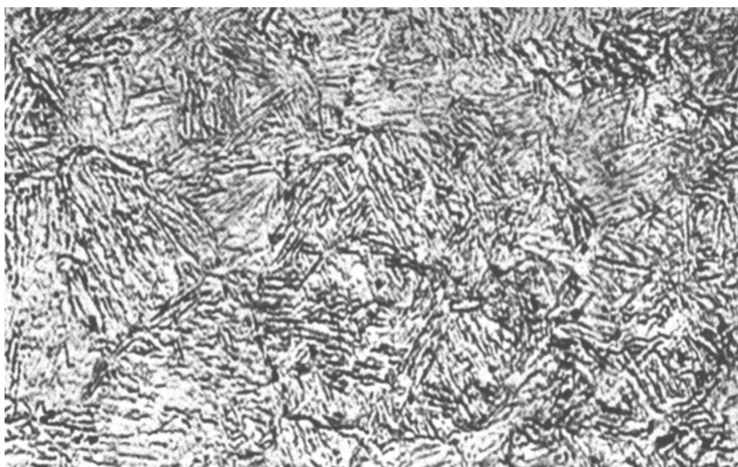
Fig. 35 – Martensita. Aço com 0,5% de carbono, temperado em água fria.
