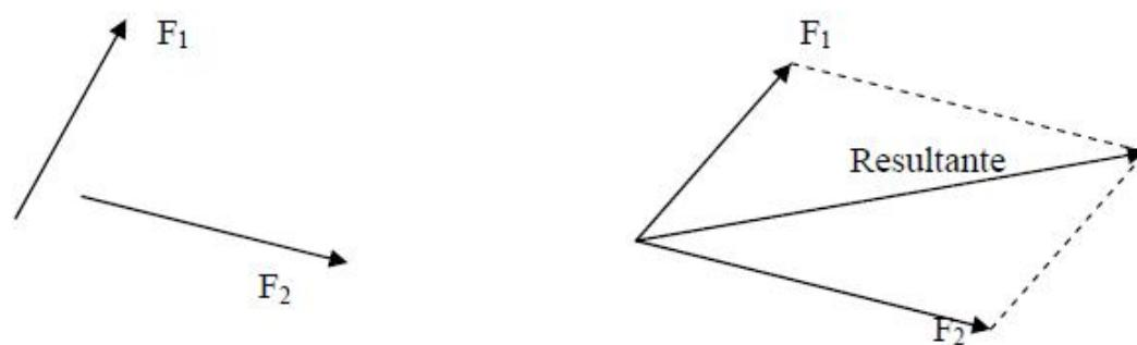
Desenha-se os dois vetores com suas origens coincidentes. A partir da extremidade do vetor  $\vec{F}_1$ , traça-se um segmento de reta paralelo ao vetor  $\vec{F}_2$ . Em seguida, a partir da extremidade do vetor  $\vec{F}_2$ , traça-se um outro segmento paralelo ao vetor  $\vec{F}_1$ . O vetor soma é obtido pela ligação do ponto de origem comum dos vetores ao ponto de intersecção dos segmentos de reta traçados.
