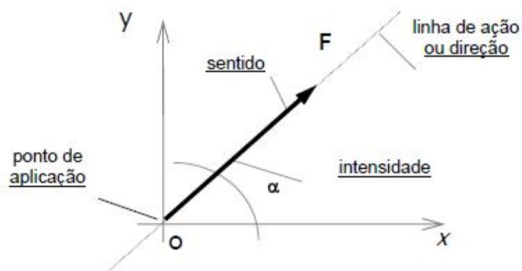
Duas ou mais forças constituem um sistema de forças, sendo que cada uma delas é chamada de componente. Todo sistema de forças pode ser substituído por uma única força chamada resultante, que produz o mesmo efeito das componentes.
