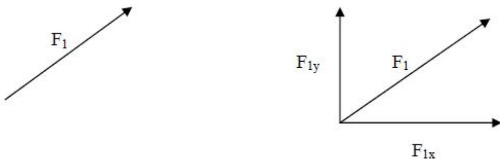
Obtem-se então duas componentes  $F_{1y}$  e  $F_{1x}$  que se forem compostas segundo a regra anteriormente apresentada torna-se a própria força  $F_1$
