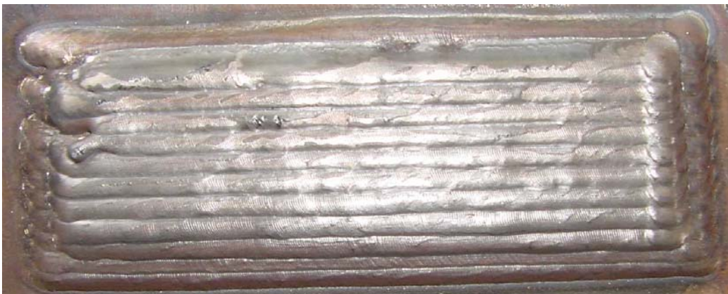
Figura 3.9 – Duas camadas depositadas com arame E-309L na posição sobre-cabeça à 45°.
