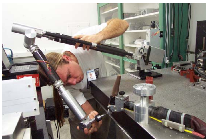
Figura 3.10 – Medição de pontos sobre a superfície da tocha através do braço de medição.
