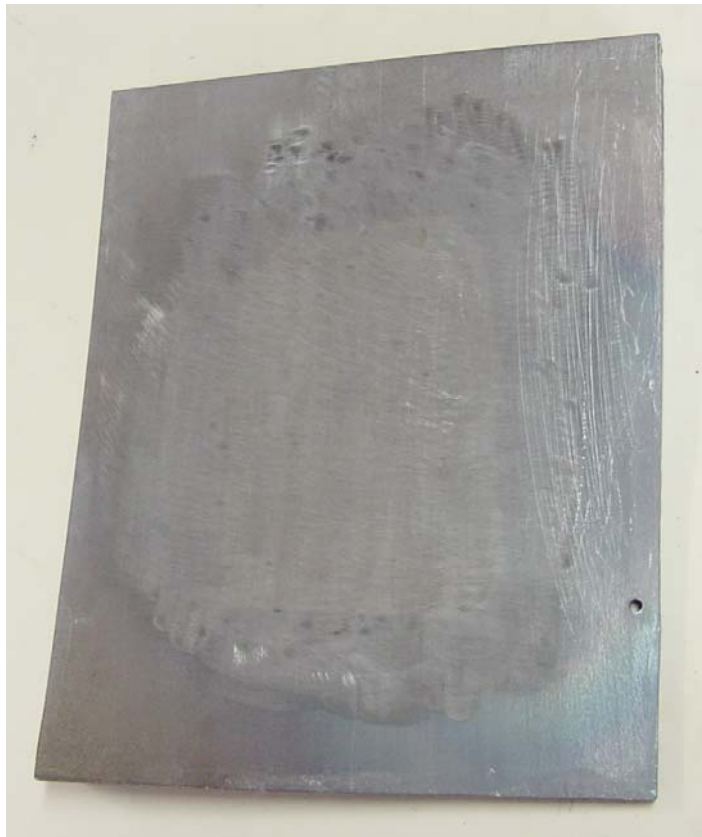
Figura 5.22 – Superfície final obtida após esmerilhamento.
