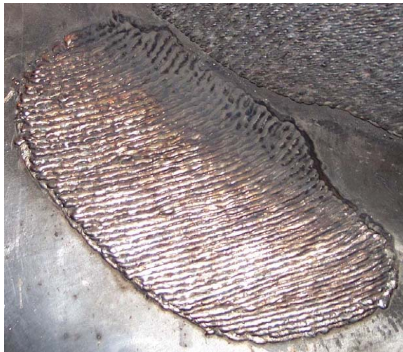
Figura 5.24 – Camadas de solda produzida pelo processo manual de soldagem MIG.
