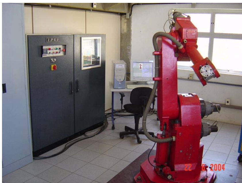
Figura 5.1 - Robô Reis Rv-15, armário de acionamento e microcomputador ao fundo.
