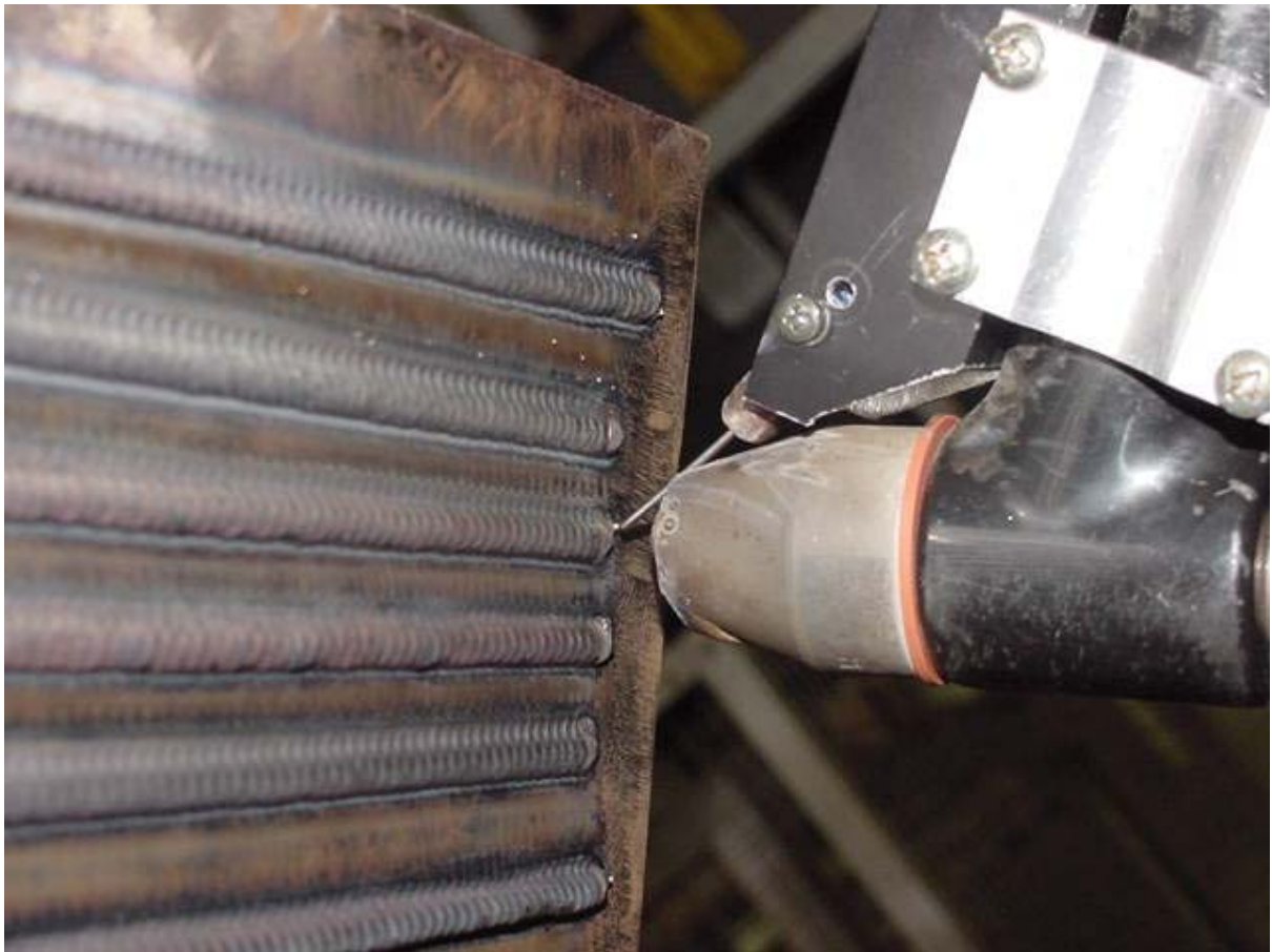
Figura 3.3 – Variação da dtp na nova estratégia de posicionamento do arame.
