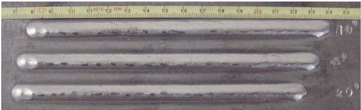
Figura 3.6 – Soldagem sobre-cabeça com diferentes inclinações.
