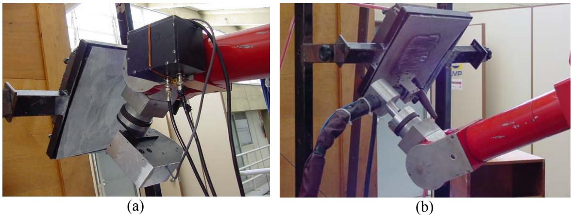
Figura 5.3 – Efetuadores do rôbo Reis: (a) Sensor óptico de três linhas e (b) Tocha plasma
