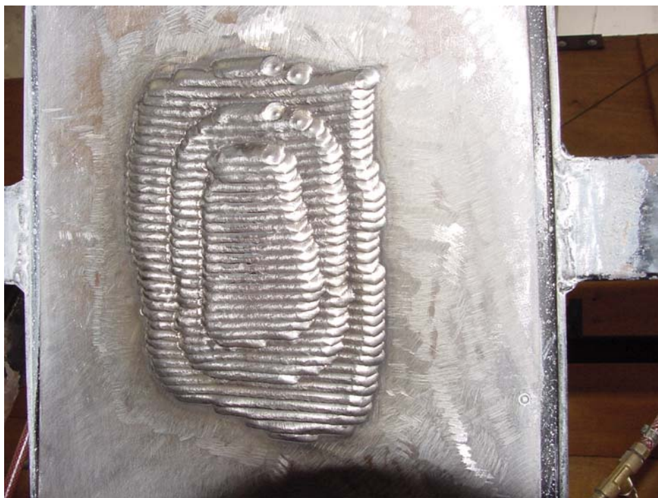
Figura 5.17 – Terceira camada de solda acrescida às anteriores.
