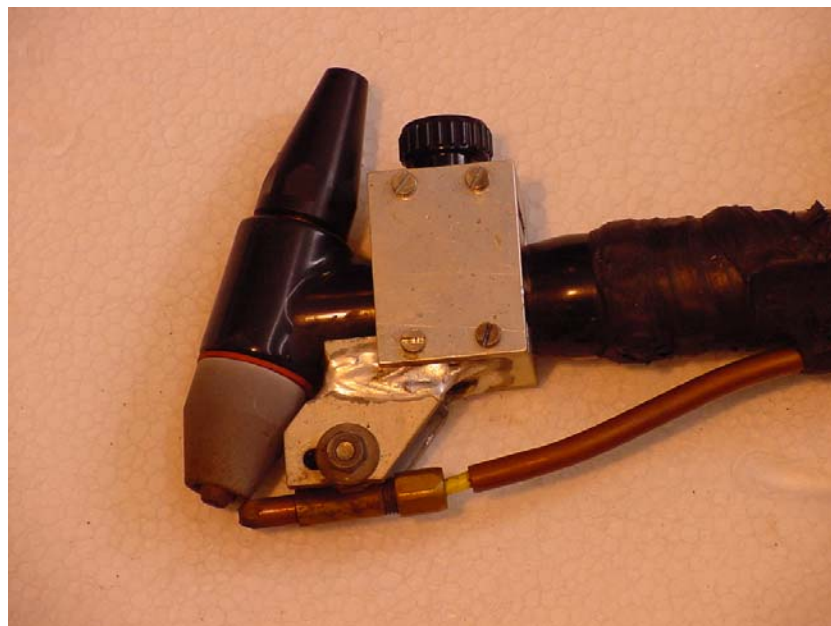
Figura 3.1 – Tocha plasma com direcionador de arame [43].
