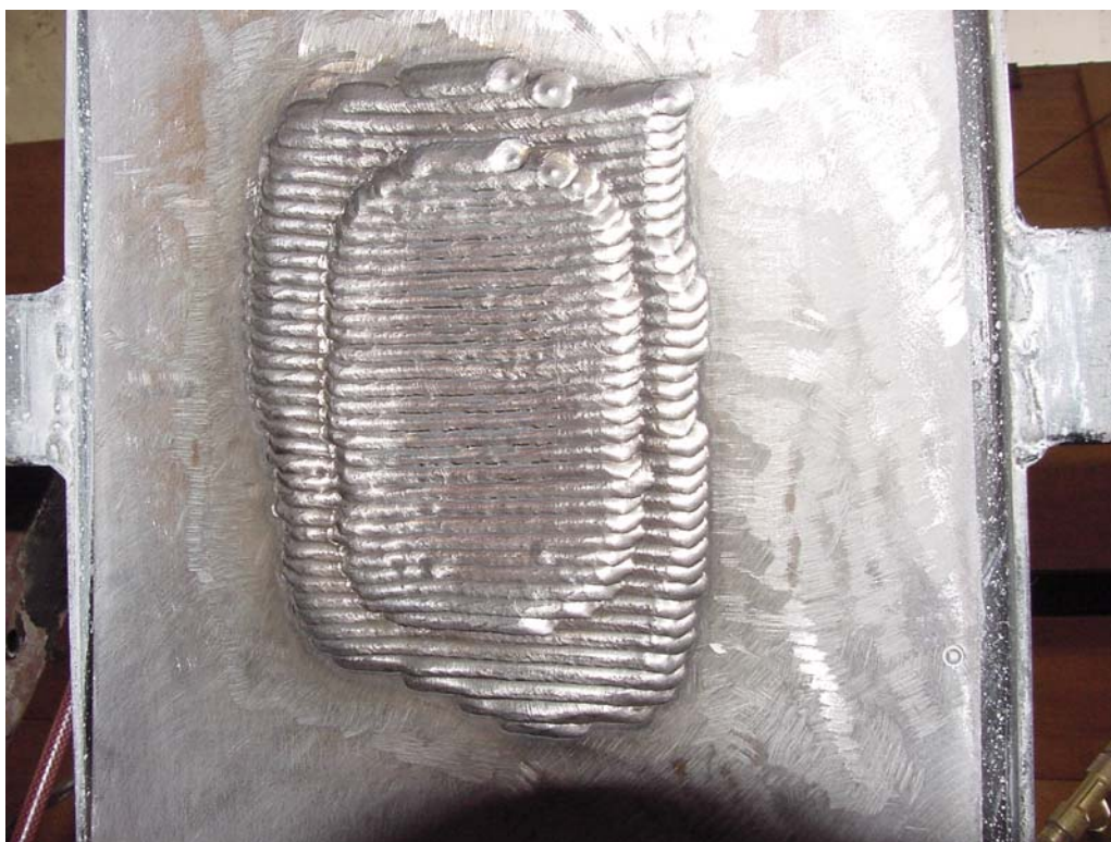
Figura 5.16 – Segunda camada de solda acrescida à primeira.
