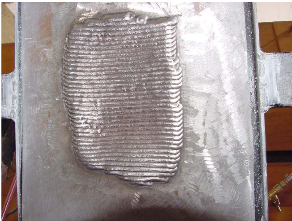
Figura 5.15 – Primeira camada de solda.
