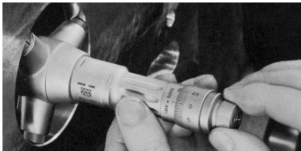
Figura 41 Foto de um micrômetro interno e exemplo de sua aplicação.
