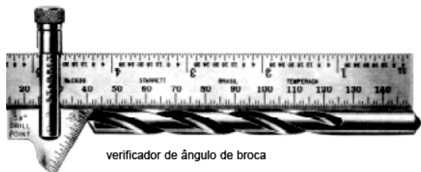
Figura 62 Foto de um verificador de ângulo de broca, mostrando uma operação de medição.
