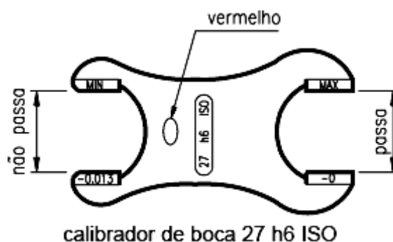
Figura 45 Desenho representativo de um calibrador de boca.
