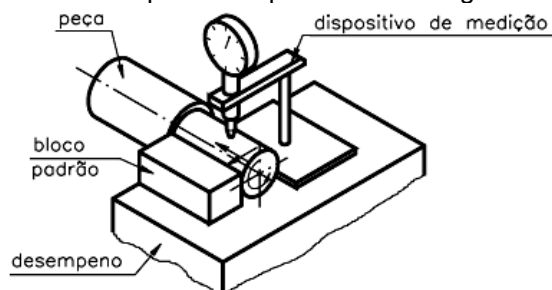
Figura 82 desenho representativo do dispositivo de medição para tolerância de circularidade.
