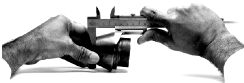
Figura 8 Foto de uma operação de medição com paquímetro universal de bico móvel.
