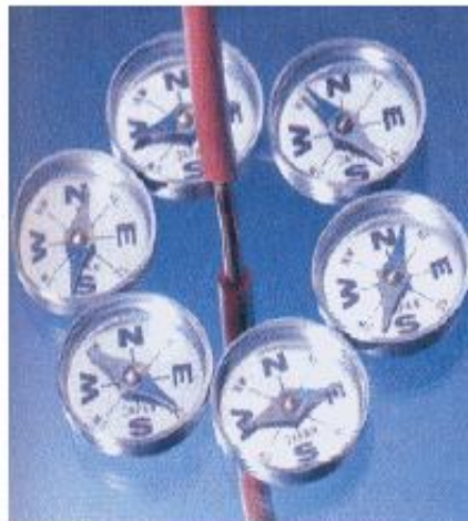
Figura 3.1 - Orientação da bússola em torno de um condutor percorrido por corrente (Fonte: Giancoli. Physics for engineers and scientists)
