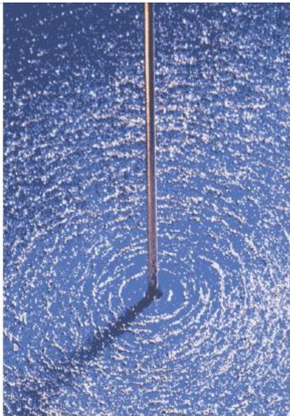
Figura 3.2 - Visualização das linhas de campo produzidas por um condutor percorrido por corrente (Fonte: Giancoli, Physics for engineers and scientists)
