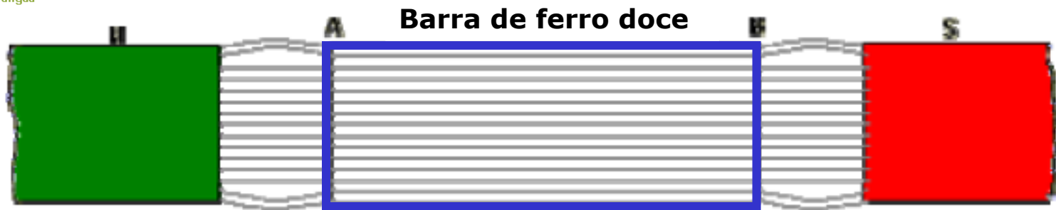
Figura 6.2 - Concentração das linhas de campo devido a um meio de alta permeabilidade.
