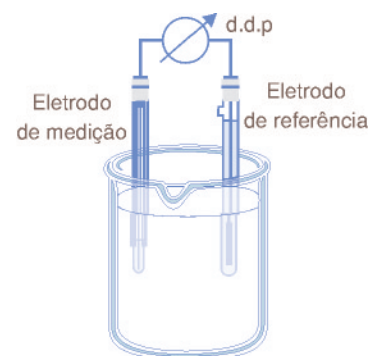
F.1 Princípio da medição potenciométrica (eletrodos separados).
