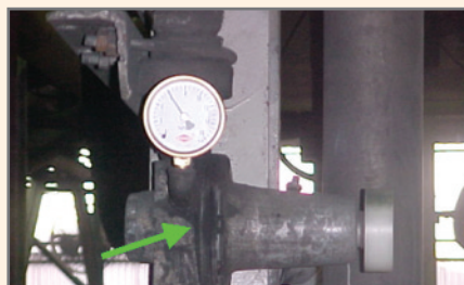
F.1 Vazamento na reguladora de pressão da máquina. Com auxílio do ultra-som detectou-se tratar de diafragma furado.
