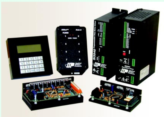
Figura 6 - IHM, Hub, dois drivers programáveis com fonte e dois sem fonte.
