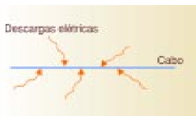
Figura 3 – Faiscamentos a cargas acumuladas.
