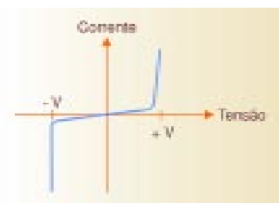
Figura 6 – Curva característica de um varistor de óxido de zinco.
