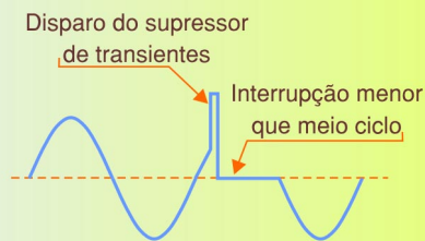
Figura 4 – Perda de 1/2 ciclo devida a proteção "Crowbar".
