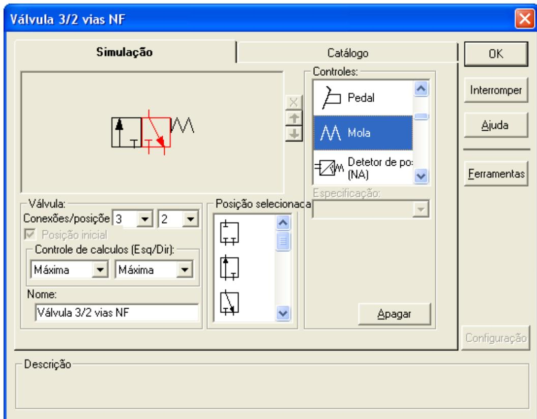
Controle Solenóide (Bobina) → duplo clique na bobina
