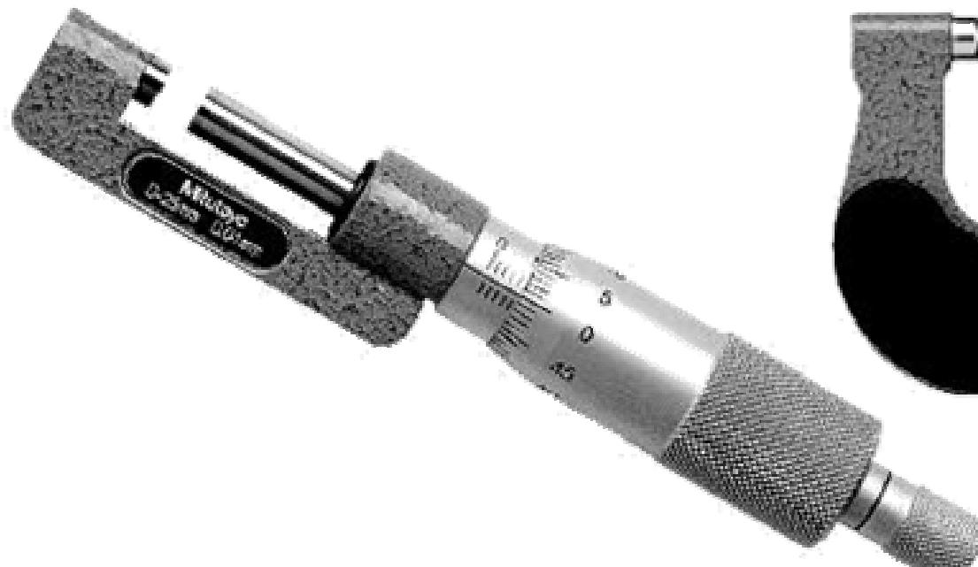
**Medição de dentes de engrenagem** - utilizado para medir as espessuras dos dentes de uma engrenagem reta, pelo método de Wildhaber;
