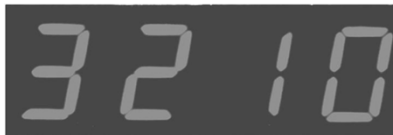
Fig. 11.9- Resultado da escrita multiplexada em 4 displays de 7 segmentos.
