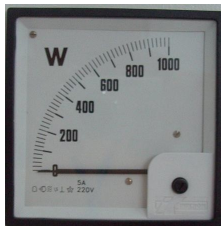
Wattímetro Fundo de Escala 1000 W Menor divisão 20 W
